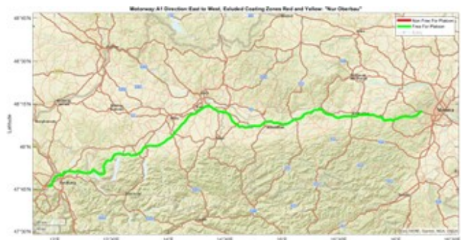
Abb. 2: Derzeit keine zu erwartende negative Auswirkung von Lkw Platooning auf den Straßenoberbau der Westautobahn A1 (Darstellung Weststrecke in der Risk-Rated-Map von ANDATA)
